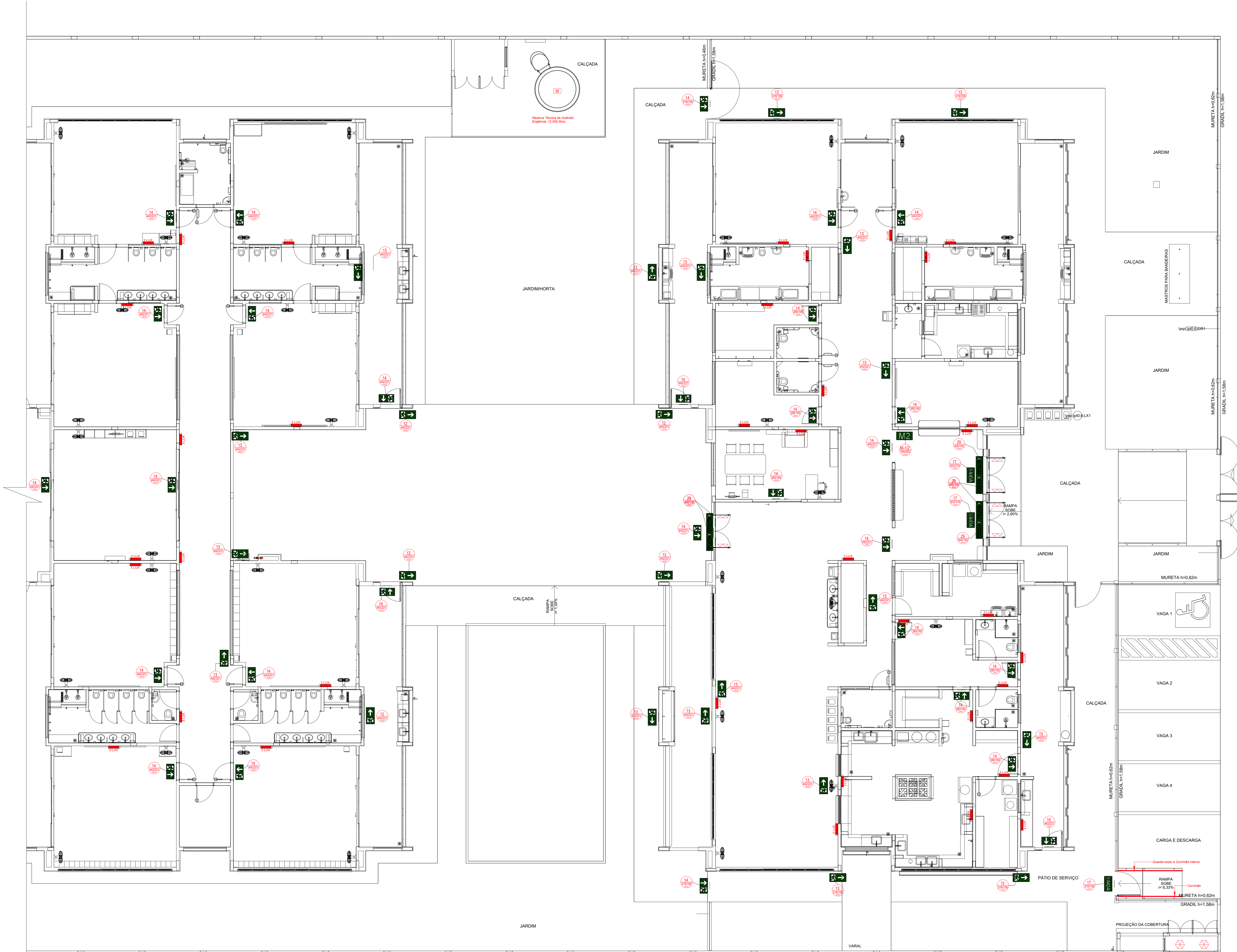
1 PLANTA BAIXA - SINALIZAÇÃO E ILUMINAÇÃO ESCALA 1/75
