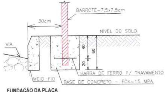
04 DETALHE DA MONTAGEM DAS PLACAS ESCALA SEM ESCALA
